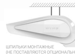
Воздушные завесы WING (водяные, без нагревателя) могут работать, как в горизонтальной, так и в вертикальной позициях. Завесы WING с электрическим нагревателем разрешено монтировать и эксплуатировать только в горизонтальном положении
